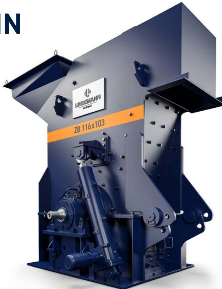
Trasforma i trucioli in materiale che può "fluire", rendendolo facile da depositare e caricare. È particolarmente adatto alla lavorazione di trucioli lunghi, ricci, folti e voluminosi di acciaio, alluminio, ottone e leghe speciali. La ZB garantisce prestazioni elevate, inalterate da pezzi sovradimensionati e con la massima efficienza economica possibile.
